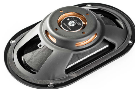
Membrana bierna o wymiarach 125 x 200 mm jest obciążona odpowiednio dobranym ciężarkiem. W ten sposób uzyskano niskie strojenie układu rezonansowego (38,5 Hz).
