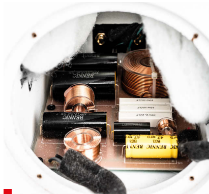
Jak na układ dwudrożny, kilkunastoelementowa zwrotnica może się wydawać bardzo rozbudowana. Owszem, filtry są wyższego rzędu, ale mamy tu także linearyzację impedancji powyżej 1 kHz.
