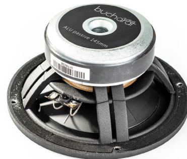
Średnica 145 mm w tym przypadku dotyczy nie kosza, lecz membrany z zawieszeniem. Ażurowy kosz i otwór w magnesie zapewniają dobrą wentylację cewki.
